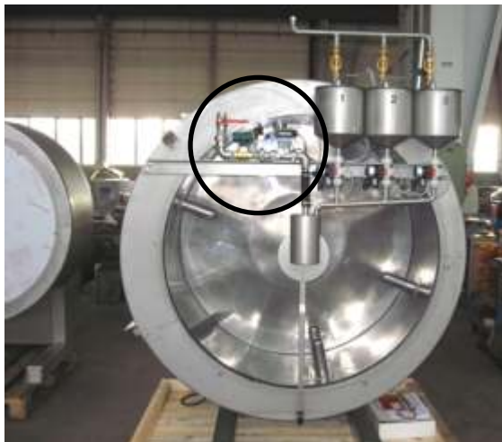
Automat. Wassermisch- und Dosieranlage
